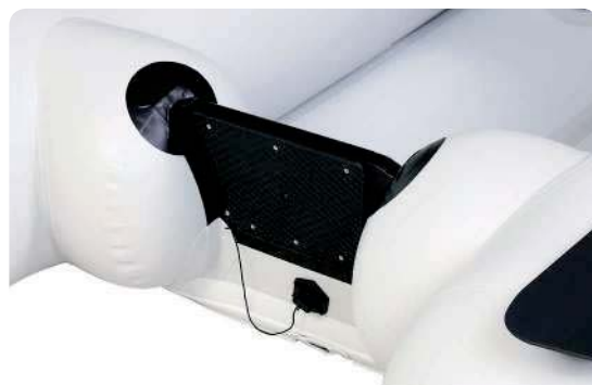
Sur annexe P240LJ : 2 renforts latéraux gonflables maintiennent solidement le tableau arrière aux dimensions réduites : pour une annexe plus légère et plus compacte une fois pliée.
