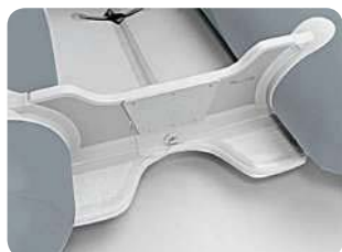
Flaps prolongeant le plancher gonflable : facilitent le déjaugage et la montée en vitesse du bateau. Stabilité accrue (Pi230VB, Pi270VB & Pi320VB).
