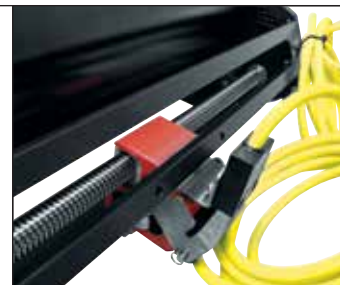
La conception adoptée rapproche la vis du tambour, conférant au winch des dimensions réduites.
