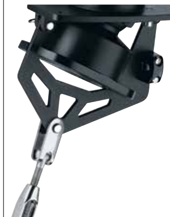
Le ridoir à œil relie l'étrier fixe de l'emmagasineur à une cadène d'étrave sous le pont.
