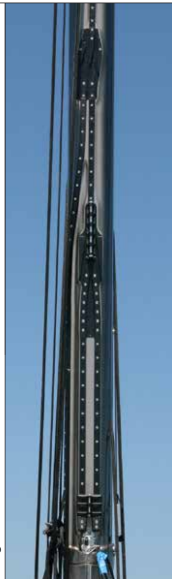
Le rail à aiguillage pour voile de cape intègre le système de chariots de latte à aiguillage sur le rail en T en place, contribuant ainsi à limiter le poids dans les hauts.
