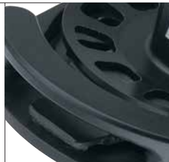
L'emmagasineur à bosse continue intègre un réa d'entraînement à lumières décalés assurant un parfait maintien de la bosse.
